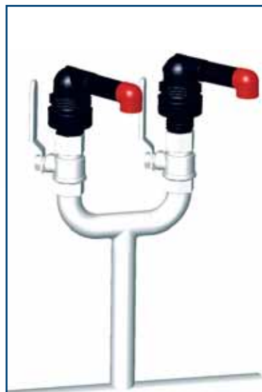
Sobre distribuidor múltiple (manifold)
