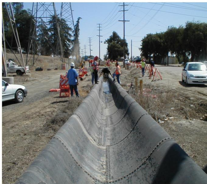
*Tubería de acero aplastada por colapso debido a presiones subatmosféricas en su interior.*
