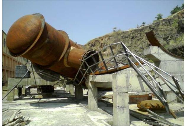
*A la izquierda se muestra un gráfico de la evolución de las presiones tras un paro repentino de los equipos de bombeo. Se puede observar que la cavidad de vapor persiste durante un largo periodo de tiempo antes de aparecer una fuerte sobrepresión. A la derecha una fotografía con los daños provocados en un evento de tales características.*
