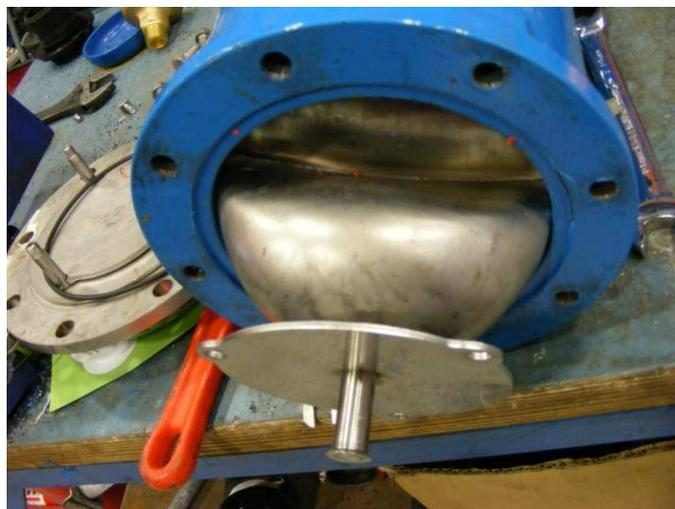
*Flotador cinético de acero inoxidable totalmente deformado por un cierre brusco.*
