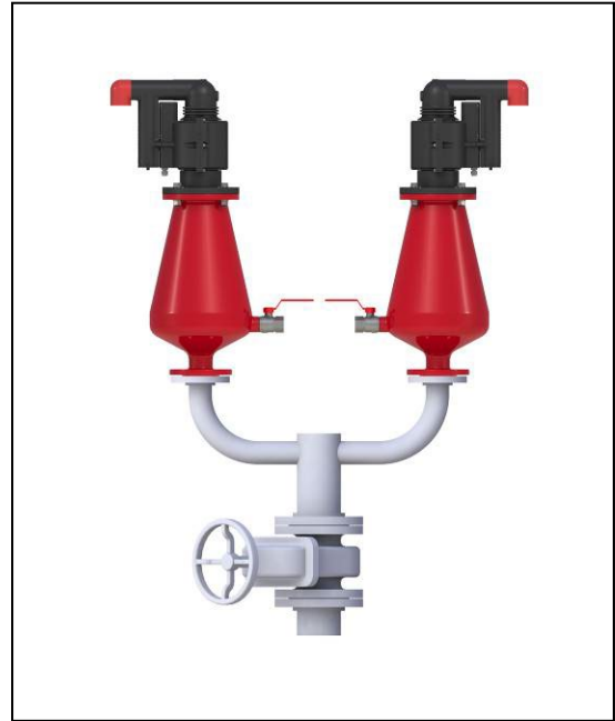
Dos ventosas sobre una llave de cierre compartida. Las salidas de las ventosas se dirigen hacia fuera y la llave de cierre a 45° de las salidas de las ventosas
