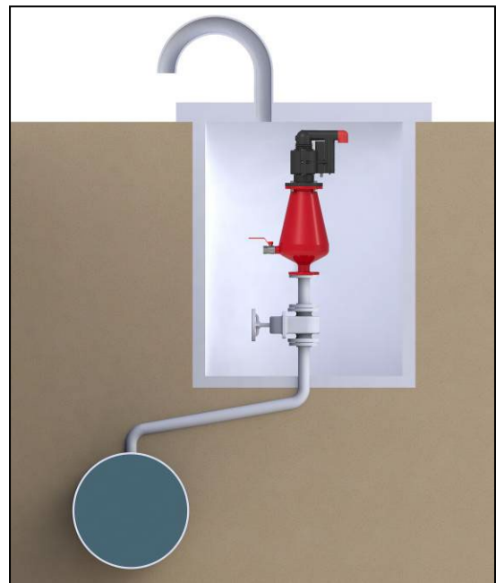
Dos ventosas sobre una llave de cierre compartida. Las salidas de las ventosas se dirigen hacia fuera y la llave de cierre a 45° de las salidas de las ventosas
