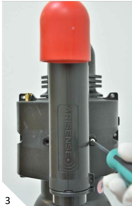
Extraer [1] y retirar la caja del detector de fugas [2].
