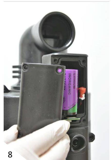
Reponer la tapa del compartimento de la batería [8] y el codo rojo de salida.
