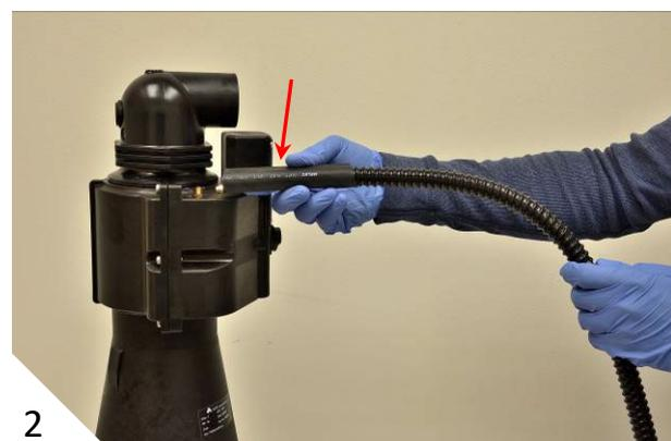
11.4 Conectar el cable de la antena al conector de la ventosa y ajustar la rosca sólo con la mano [1].
