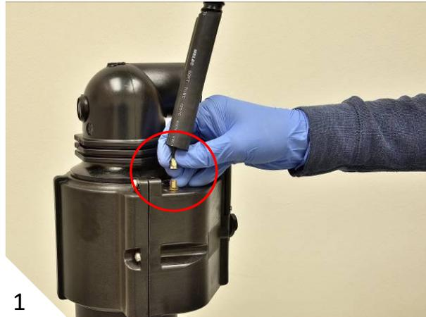
11.5 Adherir el tubo al cuerpo de la ventosa, calentarlo y encoger la manguera acopladora con una pistola de aire caliente [1], [2], [3].
