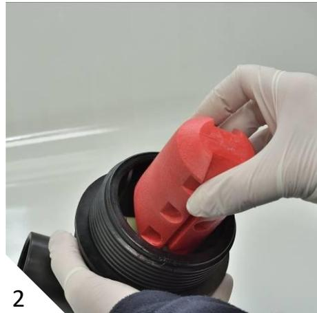
Introducir el flotador hasta la mitad del camino en el cuerpo [1], e introducir la varilla en la ranura de la goma desplegable de cierre hermético en el cuerpo, comprobando que se ha hecho en la dirección correcta como indica la figura [2]. Empujar el flotador y la varilla juntos hacia abajo hasta que estén trabados dentro del cuerpo [3].
