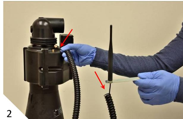
11.3 Introducir 10-20cm de manguera acopladora encogible en caliente sobre el tubo corrugado en el costado de la ventosa [1], [2].
